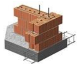
STRUTTURA IN MURATURA ARMATA
